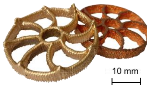
Abbildung 1: Im Verfahren MJT hergestellte Bauteile aus technisch reinem Kupfer und einer Kupfer-Zinn-Bronze.
