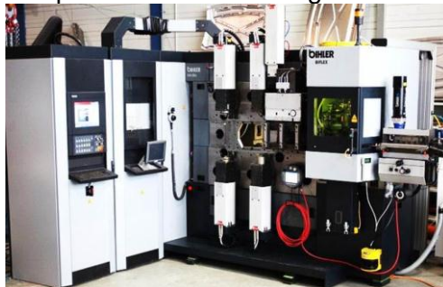
Abbildung-1: Bihler-Biflex BM 306 mit Trumpf TruDisk 1000 am utg
