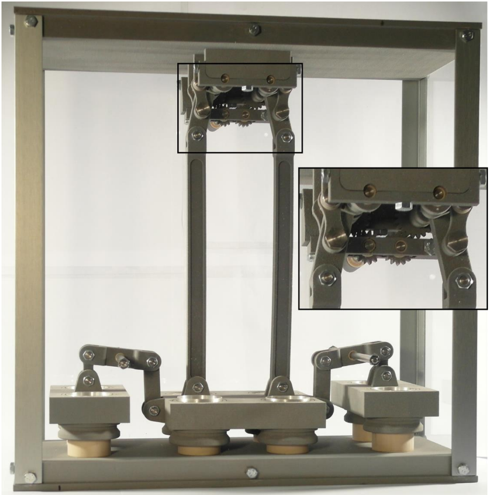
Abbildung 6.1: Rapid Prototyping Modell des Konstruktionsstandes 3 im Maßstab 1:2
